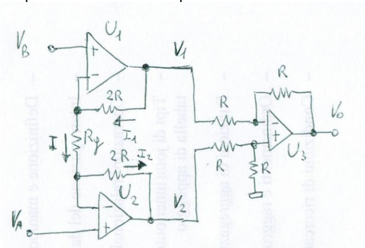
Dal circuito:  $V_{|U_1} = V_B$  per la massa virtuale, e per lo stesso motivo  $V_{|U_2} = V_A$
